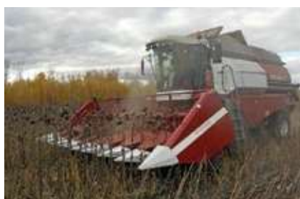
РСМ-101 «Вектор-425» с приспособлением для уборки подсолнечника ПСП-810-05
